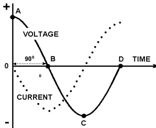
DOUBLE LAYER VOLTAGE & CURRENT WAVEFORMS
